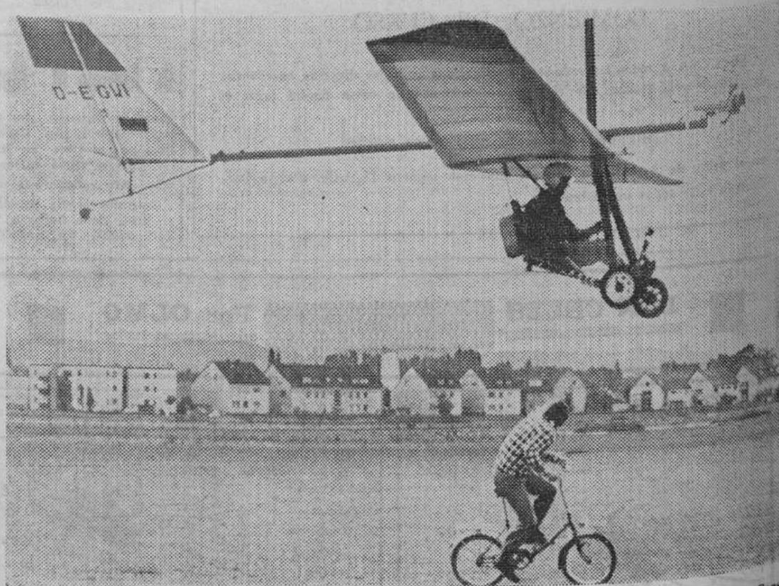
Hennel (Alemania Occidental). — Este extraño aparato, llamado «Vovi II», ha realizado su primer vuelo. Construido por Helmut Wilder, que en principio deseaba construir una cometa, está dotado de un motor de dos tiempos de 30 caballos y puede volar hasta 300 kilómetros de distancia y alcanzar una altura de 3.900 metros. Costará 10.000 marcos (unas 232.000 pesetas). Su constructor ha bautizado al vehículo con el nombre de «Vovi II».
