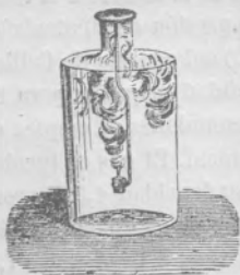
Fig. 84.—Combustión del fósforo en el óxido nitroso.
