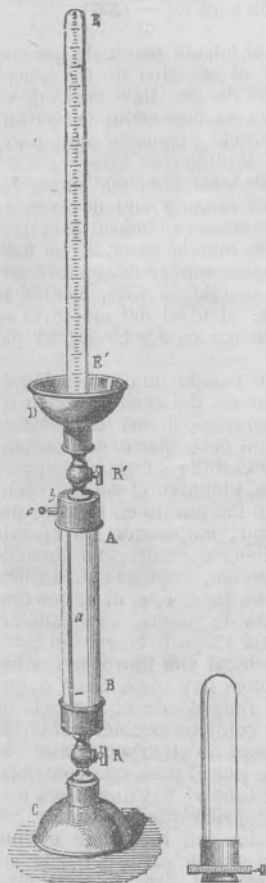
Fig. 40.—Eudiómetro de Gay-Lussac. conocido del vapor acuoso resultante, se tendrá:
