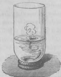
Fig. 11.3 — Descomposición del agua por el potasio.
