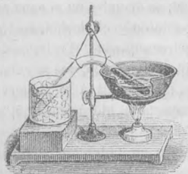
Fig. 108.—Liquefacción del cianógeno.
