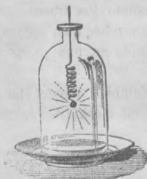
Fig. 12.—Combustión de un alambre de cobre en el cloro.
