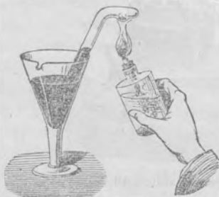
Fig. 66.—Análisis del aire por el fósforo.
