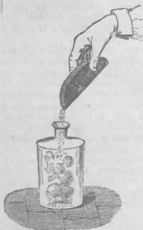
Fig. 72.—Combustión del arsénico en el cloro.
