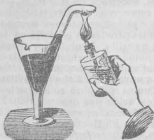
Fig. 79. - Análisis de la fosfamina.
