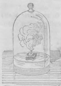
Fig. 59.—Obtención del nitrógeno.
