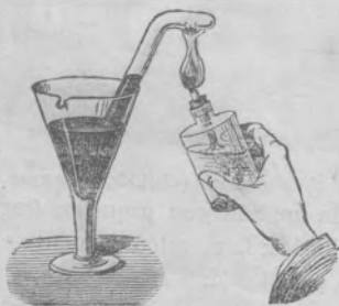
Fig. 21.—Análisis del ácido clorhídrico por el potasio.
