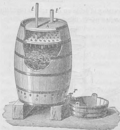
Fig. 139.—Tonel para la acetificación del alcohol.
