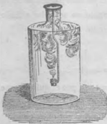
Fig. 10.—Combustión del fósforo en el cloro.
