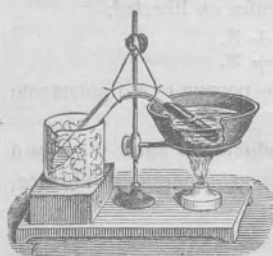
Fig. 42.—Liquefacción del ácido sulfhídrico.
