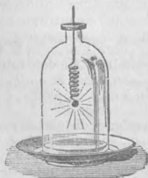
Fig. 119.—Combustión del cobre en el cloro.
