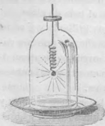
Fig. 111.—Combustión del hierro en el oxígeno.
