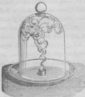
Fig. 90.—Preparación del anhídrido fosfórico.
