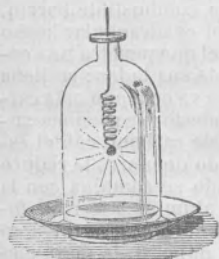
Fig. 123.—Combustión del hierro en el oxígeno.
