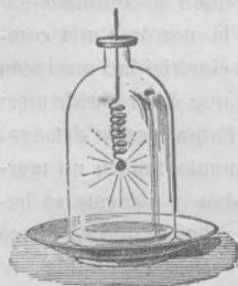
Fig. 30.—Combustión del hierro en el oxígeno.
