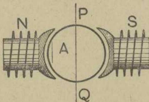
cuitos como el *A* (fig. 37), situados en el campo creado entre los polos *N*, *S* de un potente electroimán, y en cuyo circuito se mantiene la variación de flujo, haciéndole girar constantemente alrededor de un diámetro *PQ*. En cada uno de los circuitos se originará una corriente
