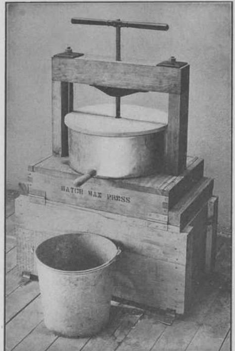
Fig. 15—La prensa de Hatch lista para extraer la cera.
