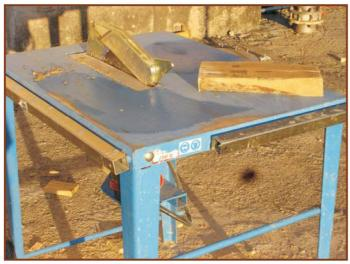
Comprobar que el punto de alimentación eléctrica dispone de interruptor diferencial, interruptor magnetotérmico y base con toma de tierra.
