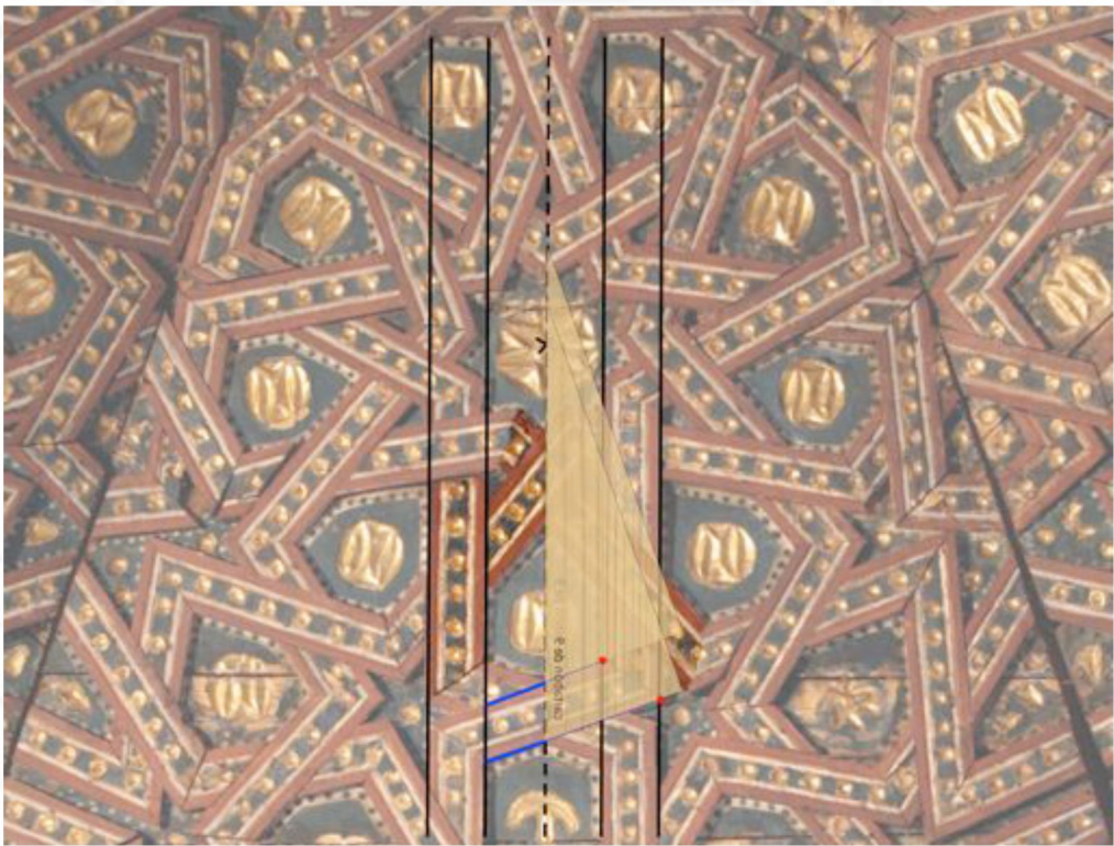
juego de cartabones para trazar una rueda de lazo de 9 puntas (V)
