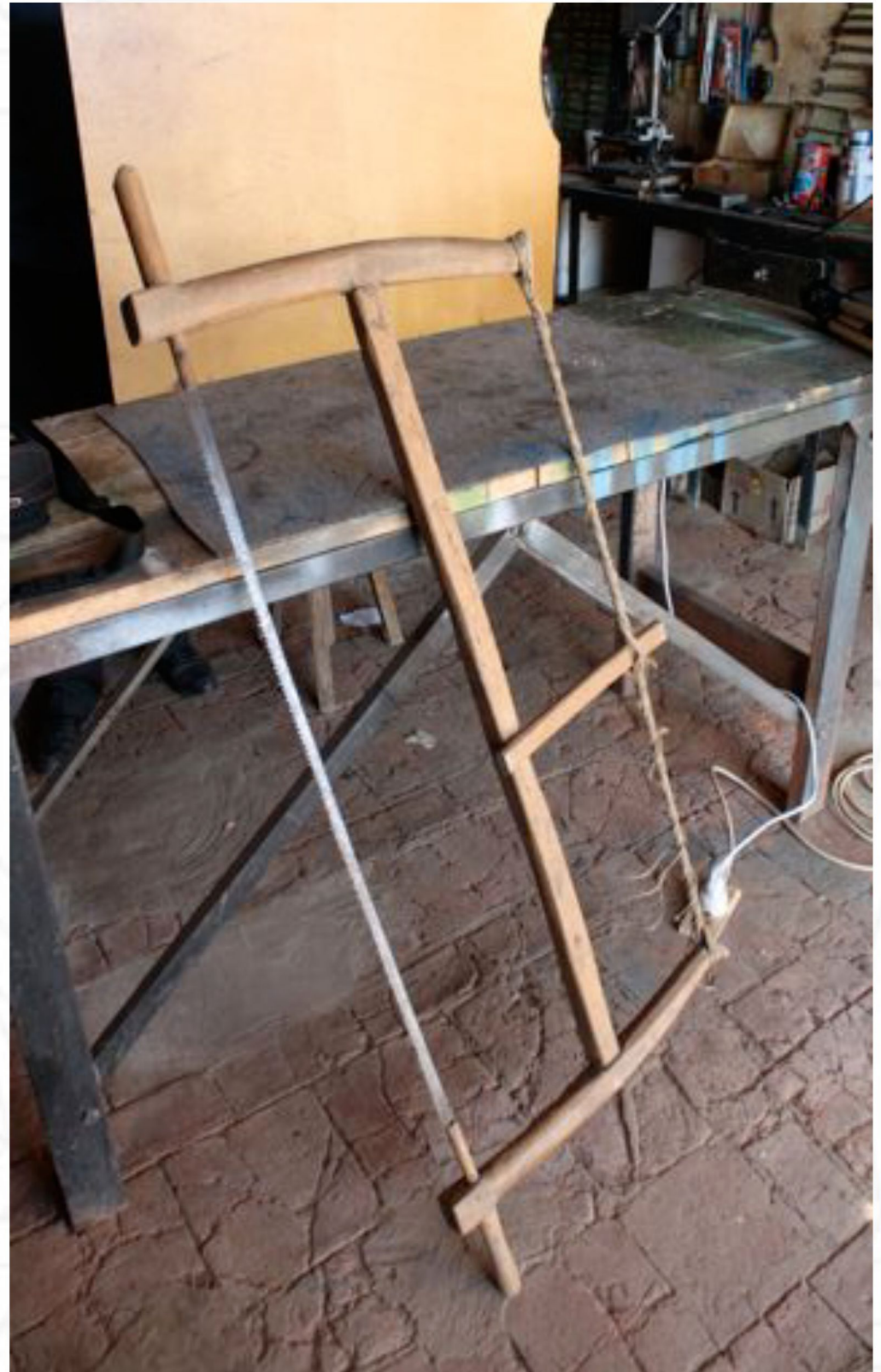
la sierra de bastidor o de ballesta era una de las herramientas básicas que en algunos contratos de aprendizaje el maestro se obligaba a entregar al iniciado
