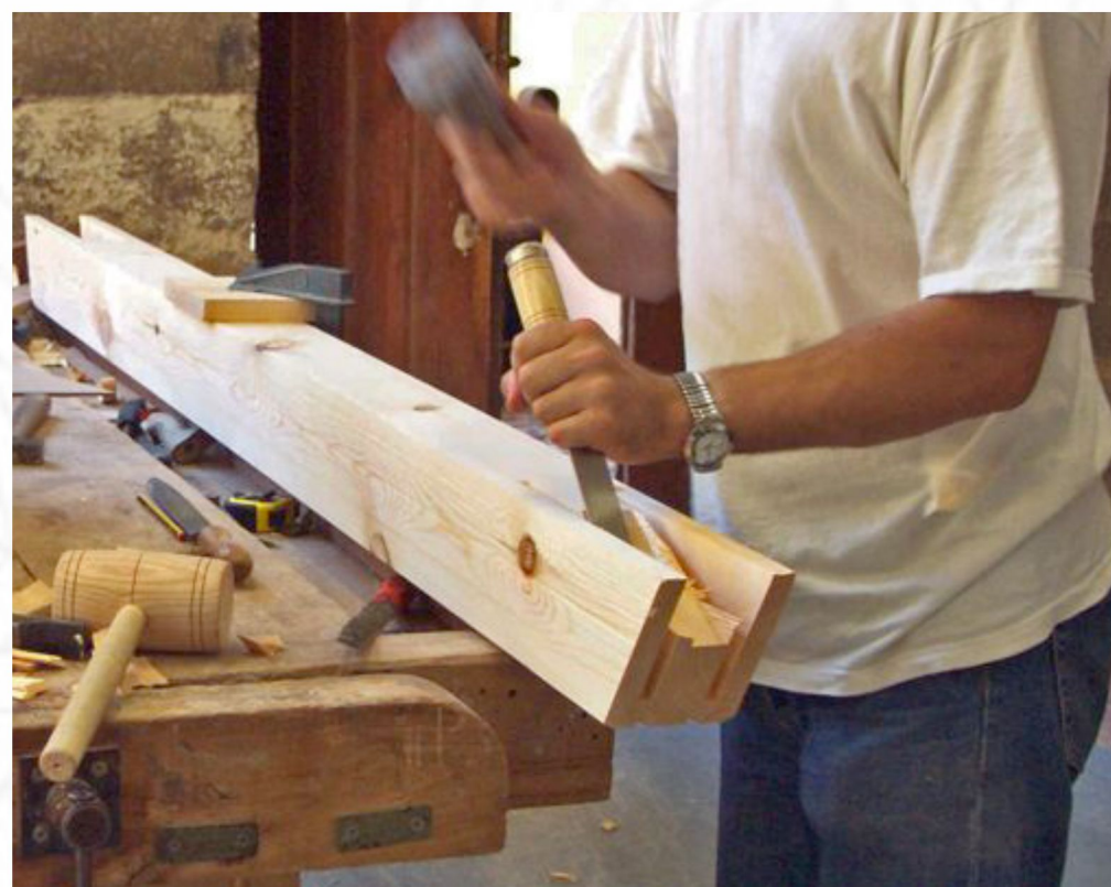
carpintero vaciando el extremo del nudillo para dar forma a los cornezuelos Centro de los Oficios, León
