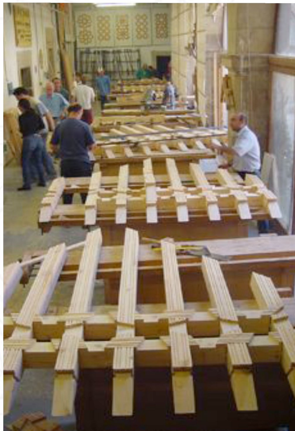
carpinteros trabajando en una armadura de cubierta Centro de los oficios. León
