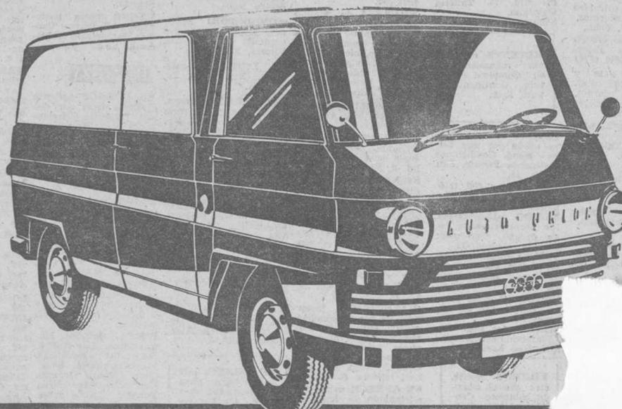
Mod. Furgón Todo metálico. Carga 1.000 kgs. y tiene un volumen de carga de 6,6 m³. Versiones: Con dos, tres o cuatro puertas laterales y una doble en la parte posterior.
