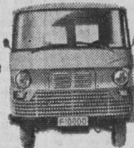
Mod. AUTO UNION-DKW F-1000-D. Especialmente adecuado para trayectos muy largos y cortos y muy frecuentes. Motor Diesel MERCEDES-BENZ 4 tiempos y 4 cilind.
