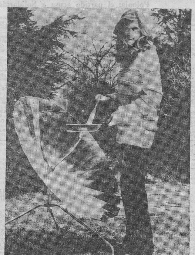
Esta «cocina solar» en forma de paraguas, se convierte en un reflector parabólico en el que se concentran los rayos solares, generándose así la energía suficiente para preparar toda una comida.
