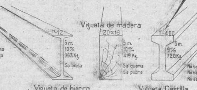
Vigueta de hierro: Luz Flecha Carga, 5m, 10%, 367 Kg, Sa oxidada
