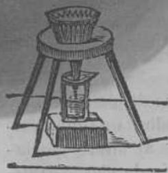
en pocos minutos decantándolo, pues que el polvo queda al fondo por su peso. Los dos ó tres primeros lavados se hacen con agua caliente, los demás con agua fria, porque cuando el óxido está ya casi bien lavado con el agua caliente sube á la superficie y se pierde una porcion decantándola. Debe advertirse que todos los lavados
