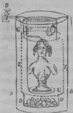
Cuando se quiere hacer uso de este aparato se coloca el diafragma que contiene una disolucion saturada de sulfato de cobre en el vaso de vidrio; se vierte en este agua salada en cantidad suficiente para que ambos líquidos estén á un mismo nivel. Se reúne entónces la plancha de la pequeña estátua al conductor de zinc, por medio de la pinza de presion y se sitúa el todo en el aparato
