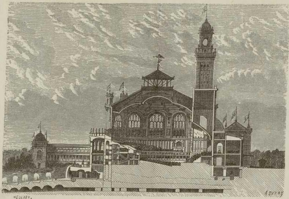
FIGURA 9.—SECCION LONGITUDINAL DE LA SALA DE ESPECTÁCULOS Y DE SUS ANEXOS.
