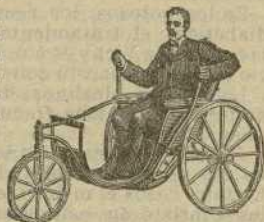
Coche movido por medio de dos palancas
