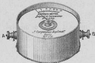
Fig. 74.—Amperómetro de M. J. Carpentier.
