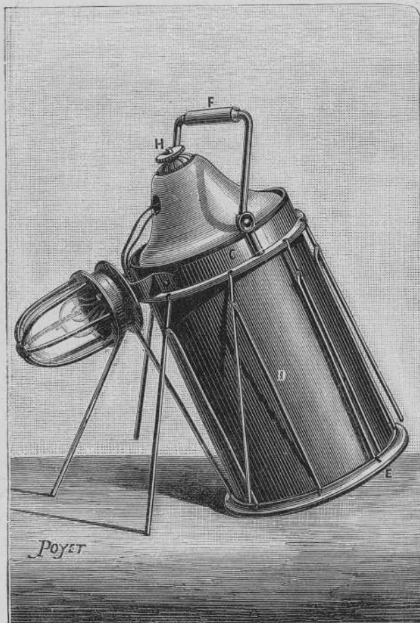
Fig. 3.—Lámpara eléctrica universal Trouvé, de seguridad, portátil, automática, regularizable é invertible, representada á un tercio de su tamaño ó magnitud natural. La figura la representa en reposo, ó sea apagada é inclinada, para hacer ver la eficacia del paracaídas.
