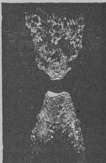
FIGURA 336.—Aspecto de los carbones en el arco voltaico.
