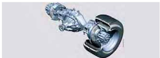
Puente de reducción
