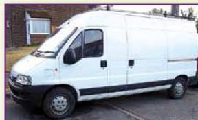
→ **Camión con MMA  $\leq 3,5$  toneladas:** el que posee una cabina con capacidad hasta 9 plazas, no integrada en el resto de la carrocería, y cuya MMA no exceda de 3,5 toneladas.
