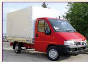
→ **Camión con MMA  $> 3,5 \leq 12,5$  toneladas:** el que posee una cabina con capacidad hasta 9 plazas, no integrada en el resto de la carrocería, y cuya MMA es superior a 3,5 toneladas e igual o inferior a 12,5. Entre los vehículos ligeros solo se incluirían los que no superaran las 6 toneladas de MMA o cuya capacidad de carga útil no excediera de 3,5 toneladas.
