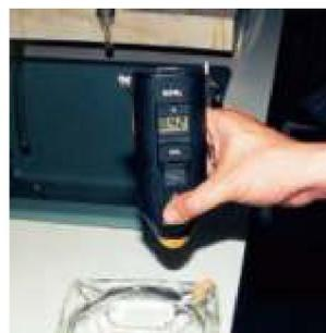
Figuras 5 y 6. Medición con tubo detector específico cuantitativo para amoníaco.
