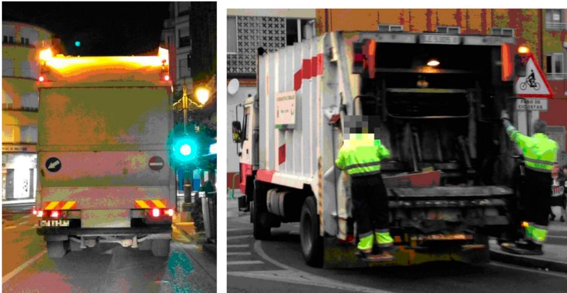
*Camión de recogida lateral (izda) y camión de recogida trasera (dcha). Fuente: propia*
