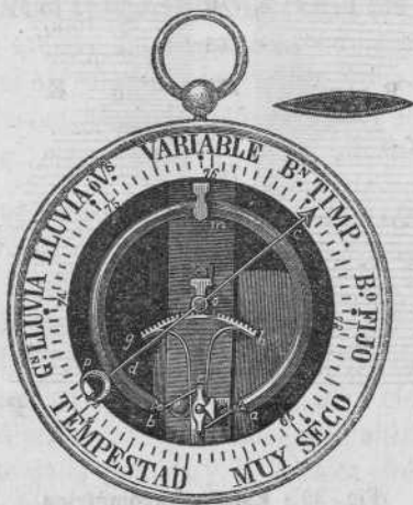
(Fig. 40.) Barómetro metálico.
