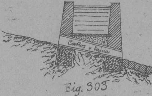
Canal entre muros
