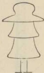
Fig. 107.—Aislador de alta tensión.
