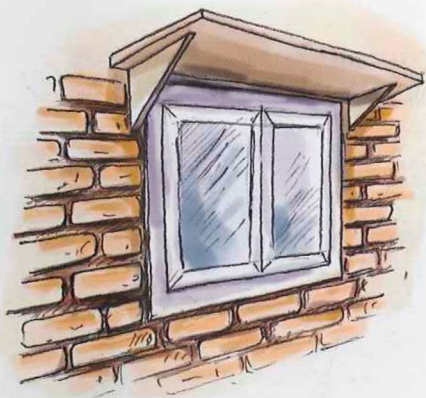
Una simple repisa colocada sobre ventanas o puertas es suficiente para evitar que caiga guano.
