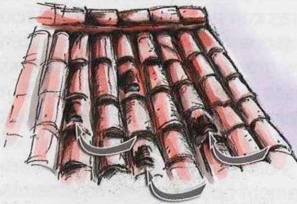
Tejado con tejas especiales para que sean ocupadas por murciélagos.
