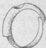
*Anilla inferior del portafusil*, con su base, que se fija con dos tornillos á la culata.
