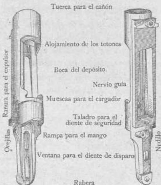
**Cerrojo.**—Comprende los mecanismos de obturación, percusión, extracción y seguridad.
