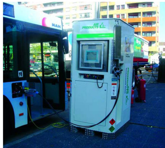
Repostaje de un autobús en una hidrogenera
