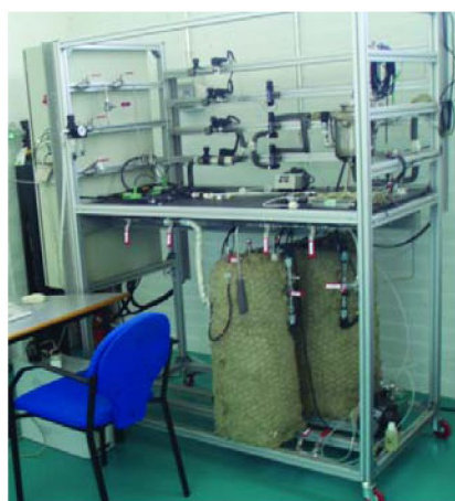
Banco de ensayos de sensores de H 2 . Proyecto STORHY
