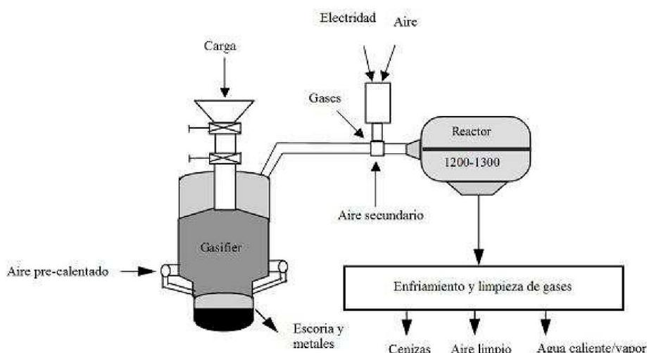
Esquema proceso. Fuente: *Gasification and Pyrolysis Treatment of Hazardous Waste*
