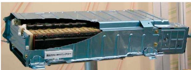
Batería Ni-MH de alta potencia. Fuente: Toyota
