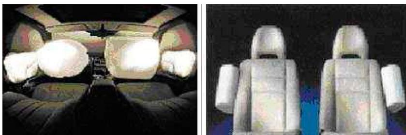
Tipos de montaje de airbags laterales
