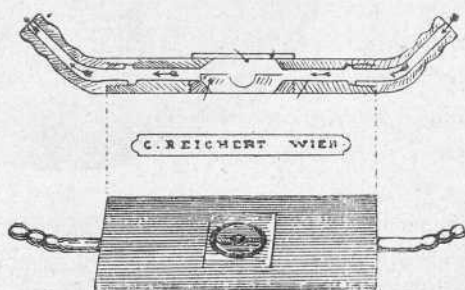
FIG. 7. a —Aparato de Reichert para la observación ultramicroscópica de los gases, visto de plano y en corte vertical.
