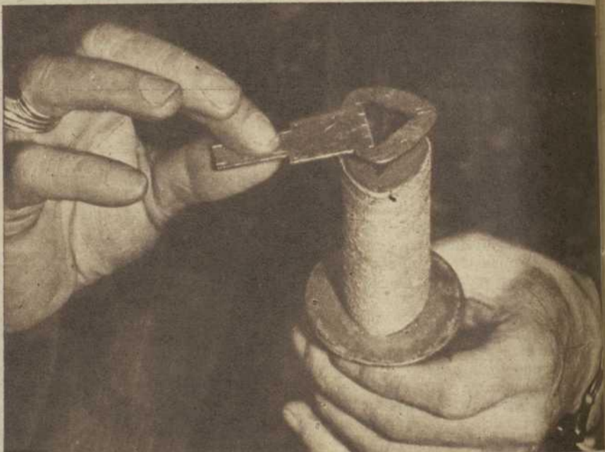
Con el escantillón oficial se comprueba la anchura de la puya...
