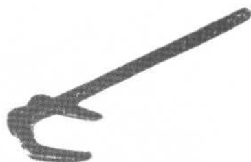
Fig. 15.—Instrumento especialmente aplicado a la extracción de remo'acha y conocido con el nombre de caco .
