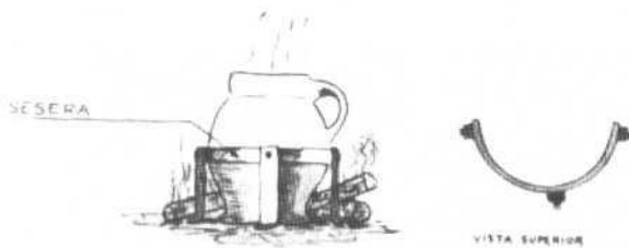
Fig. 42.— Sesera . Resulta muy útil para mantener el equilibrio de pucheros o recipientes sobre el hogar.
