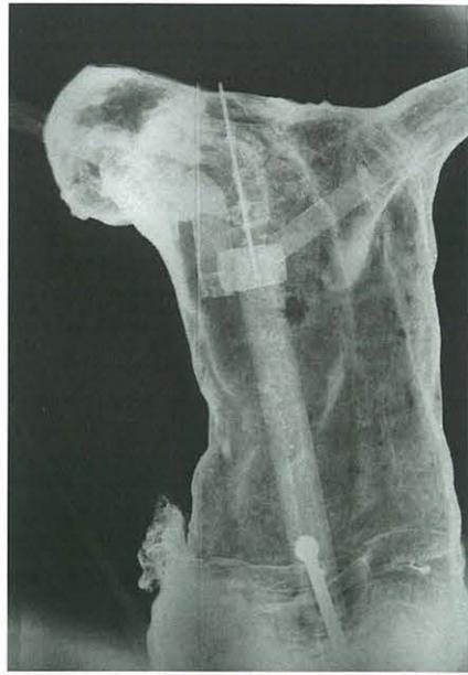
Radiografía de la estructura interna de sujeción, colocada en la restauración.
