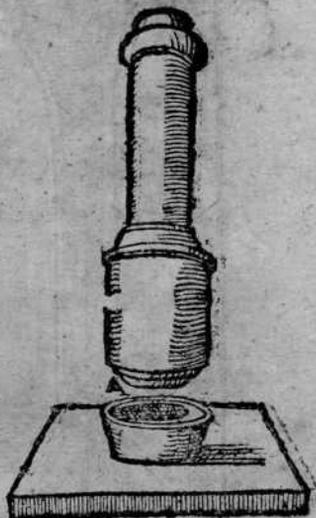
El hornillo del ensaye, se haze su armadura sobre barras de hierro, y el suelo es de parrillas, y muy llano. Despues se guarnece de varro arenoso por dentro, y fuera, de manera que todo el hierro quede cubierto, salvo el suelo: y tiene de diametro en el hueco, vn palmo: y de alto, dos palmos. Serà redondo, como se muestra en esta figura: y junto al suelo de las parrillas, ha de tener vna boca A. por donde entrè,
