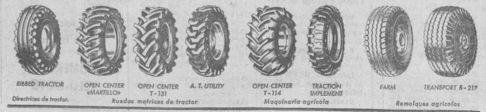
RIBBED TRACTOR, OPEN CENTER «MARTILLO», OPEN CENTER T-131, A. T. UTILITY, OPEN CENTER T-114, TRACCIÓN IMPLEMENT, FARM, TRANSPORT B-21P. Directrices de tractor. Ruedas matrices de tractor. Maquinaria agrícola. Remolques agrícolas.
