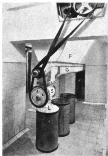
Fig. 34. — F, tolva donde cae la leche en polvo. = G, caja donde está alojado el tornillo sin fin. = S, dispositivo de salida y descarga de la leche en polvo. = L, leche «VENTOSILLA», en polvo. = Se ha suprimido en esta foto el cierre del depósito, que ajusta a S, a fin de que se vea L. Dicho cierre, visible en la figura 35, evita el contacto de L con el ambiente.
