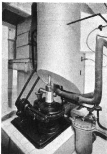
Fig. 33. — Mecanismos inferiores de la torre de desecación en la fábrica «VENTOSILLA». = I, entrada del aire, para desecación, hacia dicha torre.
