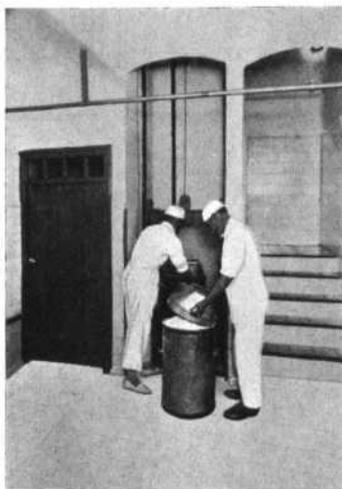
Fig. 35. — En la fábrica «VENTOSILLA», inmediatamente de caer la leche en polvo en estos depósitos herméticamente cerrados es subida en un montacargas eléctrico a la sección de envasado.
