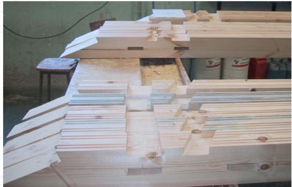
maderas “labradas” y de aspecto blanquecino para la elaboración de una armadura de cubierta
