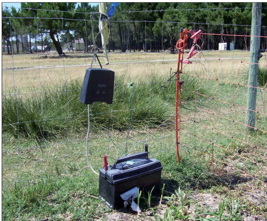
Figura 18: Pastor eléctrico conectado a una batería.
