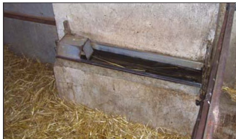
Figura 9: Bebedero nivel constante tipo canal.
