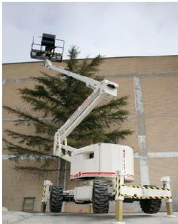
Figura 6.26- Foto de una plataforma elevadora autopropulsada con brazo articulado y telescópico.
