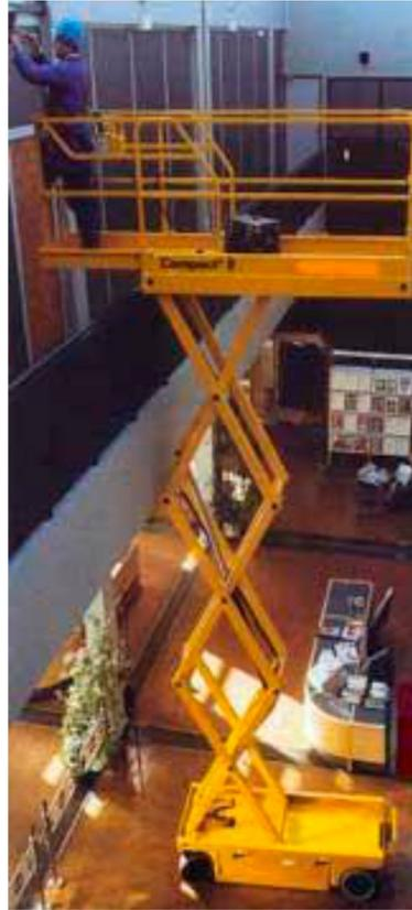
*Figura 6.24- Foto de una plataforma elevadora autopropulsada de tijera.*
