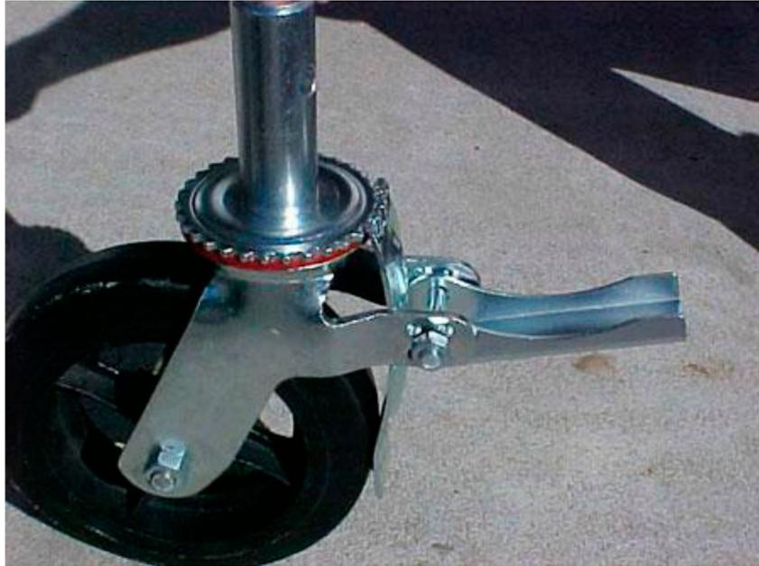
Figura 6.16- Foto de una rueda de andamio dotada de freno.
