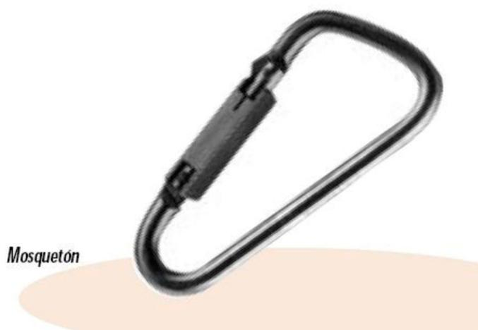
*Figura 6.39- Mosquetón con cierre de seguridad automático. Las conexiones que componen cada uno de los sistemas anticaídas han de efectuarse mediante conectores de tipo mosquetón o gancho que cumpla la norma UNE-EN362:1993.*
