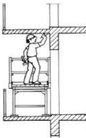
*Figura 6.12- Figura que representa un andamio de borriquetas protegido por barandillas de seguridad.*
