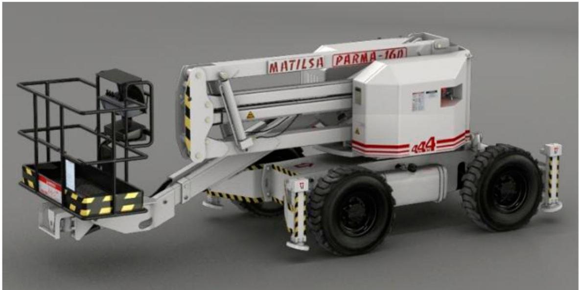
Figura 6.27- Foto de una plataforma elevadora autopropulsada con brazo articulado y telescópico.
