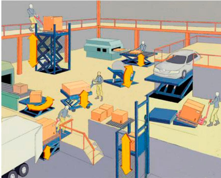
Figura 6.20- Figura donde se representan diferentes tipos de plataformas elevadoras.
