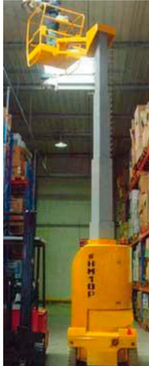
Figura 6.25- Foto de una plataforma elevadora autopropulsada con brazo telescópico.
