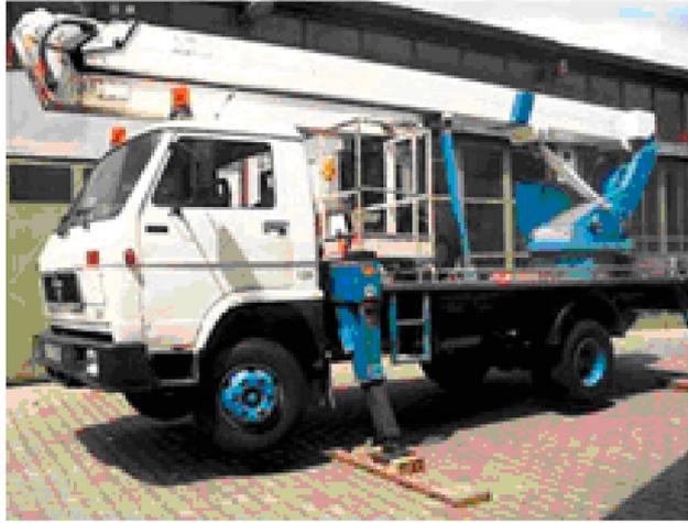
*Figura 6.23- Foto de una plataforma elevadora con brazo articulado y telescópico montada sobre camión.*
