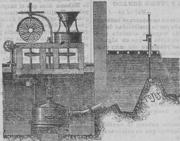
Molino de castillete de madera con turbina
