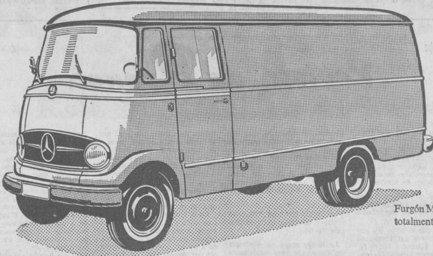
Furgón Mercedes-Benz L 319 D. Estructura y carrocería totalmente estampadas y pintadas al horno.
