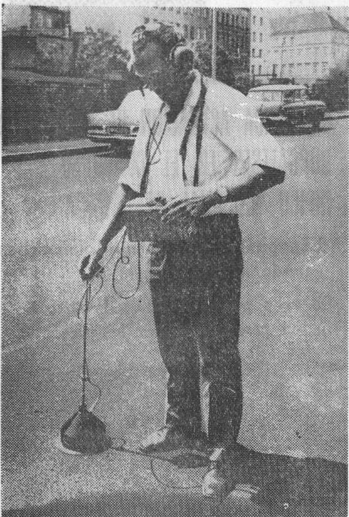
Debido a la escasez de agua que padece la capital austriaca, equipos especiales buscan incansablemente, de día y de noche, posibles roturas de cañerías y escapes, con modernos aparatos electrónicos que detectan las mismas a profundidades de hasta cuatro metros. En esta fotografía vemos a un técnico realizando en plena calle su labor detectora con el citado aparato.
