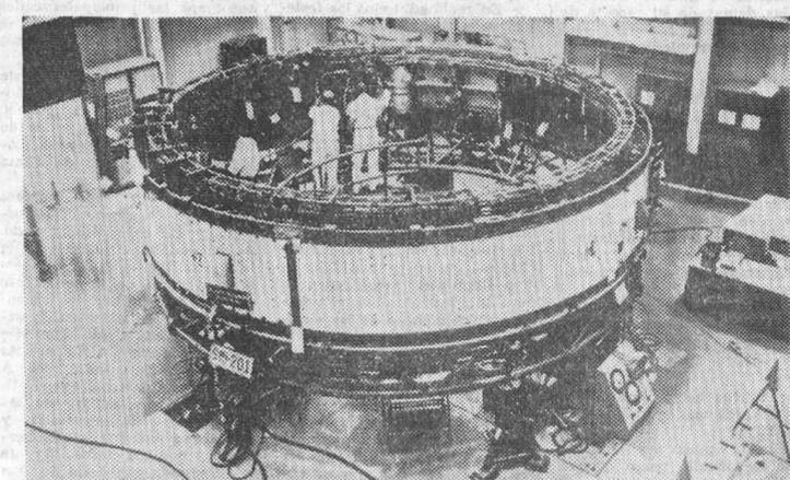
La fotografía muestra un momento del montaje del cerebro del gran proyectil «Saturno I. B.» de la NASA. Estas unidades instrumentales, construidas, probadas y montadas en las instalaciones de I. B. M. son el puesto de mando de los vehículos «Saturno I. B.» y «Saturno V».
