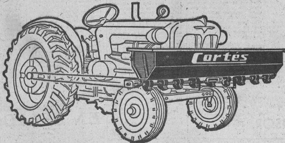
Totalmente metálicas; adaptables a todo tipo y marca de tractor, de ruedas y orugas, de colocación frontal para siembra "a voleo". Distribuidores en Delrin, en material plástico que no necesita engrase. Por su bajo costo, amortizable en un año.
