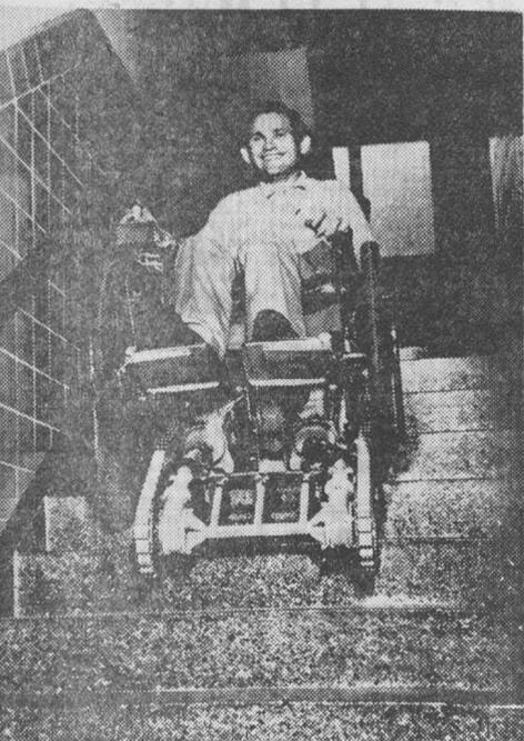
En Alemania ha sido presentado este modelo de silla de ruedas para invalidos dotado de un mecanismo especial para subir y bajar escaleras. En la foto vemos como un impedido hace una demostración. — (Foto FIEL)
