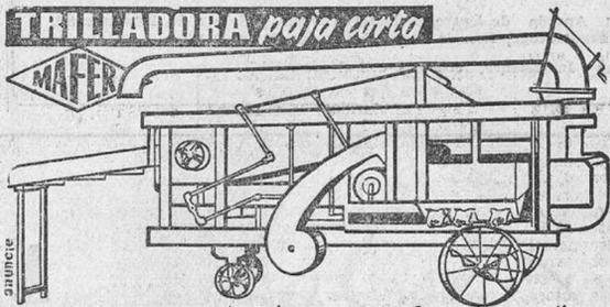
TRILLADORA MAFER equipada con plataforma para alimentarla y centrifugo lanzapajas-no parte el grano y lo deja perfectamente limpio y envasado • rendimiento 4.000 kgs.-potencia 12 hp pidan detalles a Venancio Fernandez e hijos Perez Galdos, 5, Valladolid
