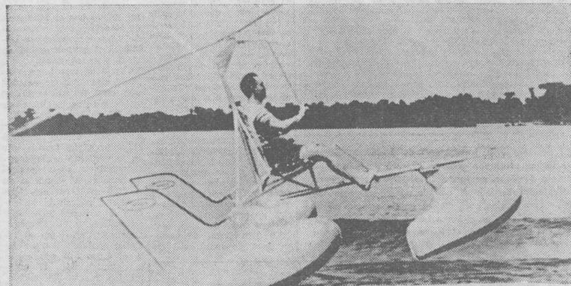
Este helicóptero sin motor se llama «Botas Grandes» y puede aterrizar y despegar sobre la superficie del mar. Es arrastrado por una motora hasta que sus aspas comienzan a girar con velocidad suficiente para hacer posible su despegue. Tras de lo cual, y después de planear durante algún tiempo, vuelve a aterrizar a salvo sobre las aguas. Por supuesto, requiere un alto grado de entrenamiento. (Foto FIEL)
