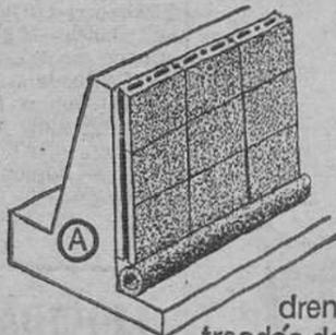
(A) con empleo de bloque poroso y recogida con tubería porosa
