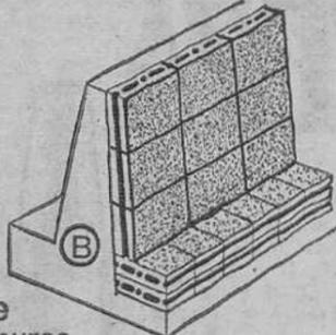
(B) con empleo de bloque poroso y recogida con el propio bloque poroso
