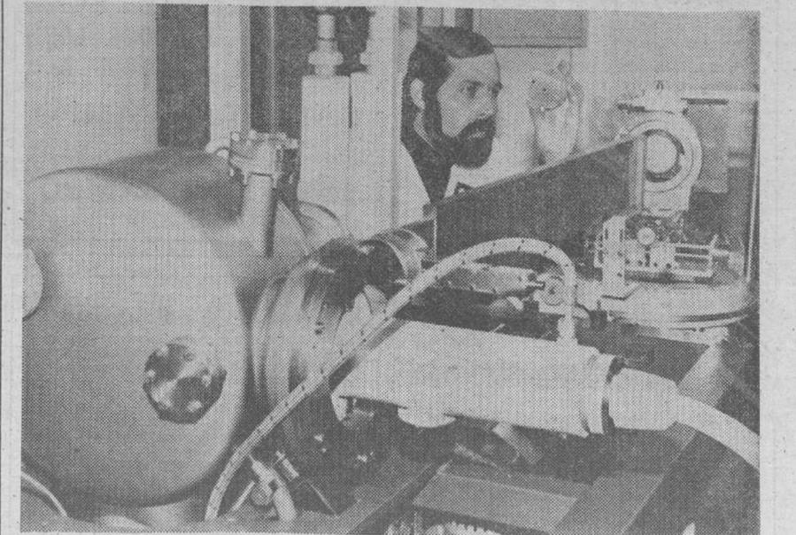
El aparato de la foto se aplica para radiografiar cristales semiconductores de los utilizados en la fabricación de componentes electrónicos. Se trata de un tubo de Rayos X utilizado por los laboratorios de Siemens en Munich y que, dotado de rotación muy rápida, se reconoce como el más potente del Mundo. Por primera vez los defectos de una estructura cristalina pueden ser apreciadas directamente, sin necesidad de placas fotográficas. — (Foto FIEL).
