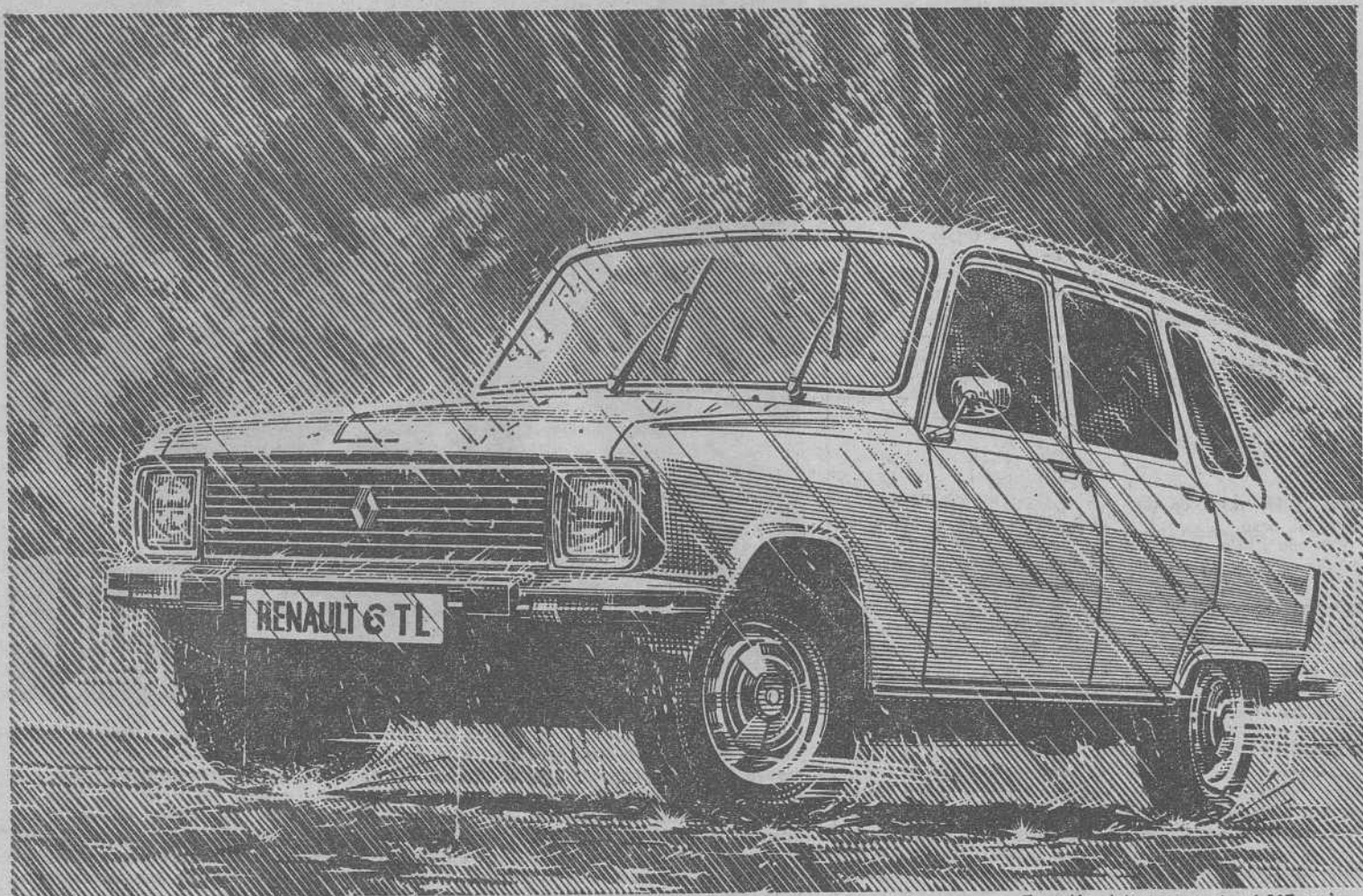
Tracción delantera, motor 1.037 cm 3 .
