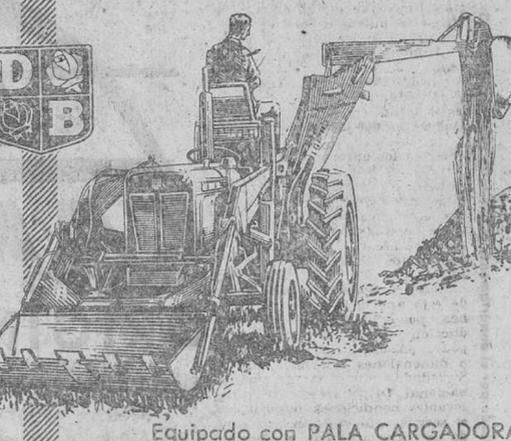
Equipado con PALA CARGADORA-FRONTAL de 260 litros de capacidad y PALA RETROEXCAVADORA TRASERA, para una profundidad de trabajo de 3,60 m.
