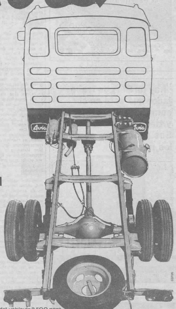
Bastidor del vehículo 2.500 para cualquier tipo de carrocería.
